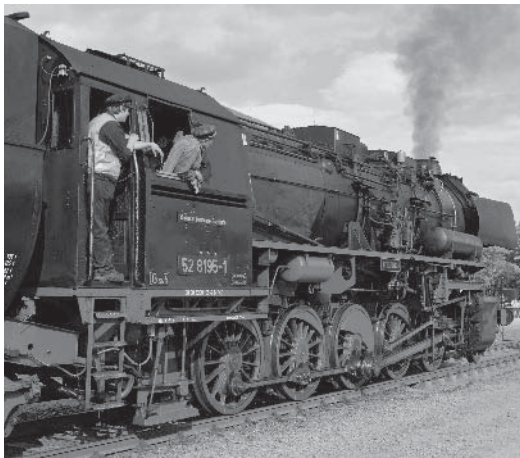
De wielen van de locomotief bewegen door drijfstangen.
