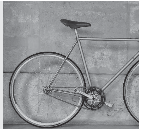
De tandwielen draaien in dezelfde richting.
